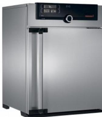
Уникально всестороннее поверхностное топление которое инкубатор im Memmert отличает совершенно как для естественной конвекции, так и для того чтобы принудить-циркуляция воздуха. Вентилятор может быть выключен полностью-без влияния на оптимальное распределение температуры.
